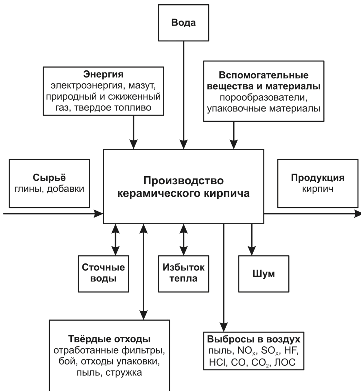
Рисунок 3.1 — Входные и выходные потоки в производстве керамического кирпича [80], с изменениями и дополнениями [15]
